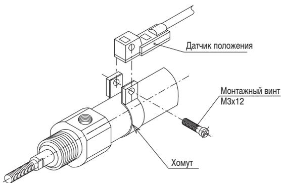
1. Смонтируйте хомут вокруг цилиндра в месте установки датчика и затем расположите его совместно с датчиком положения.
